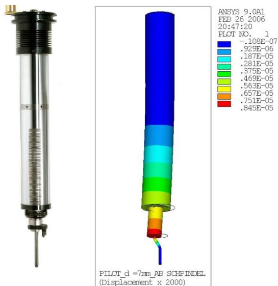
Рис.10. Жесткая шпиндельная система (слева) и характер ее деформации (справа)
