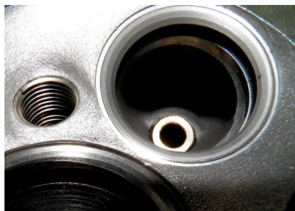
Рис.7. Седла клапанов, обработанные 3-угловым профильным резцом - такой способ обработки применяется в обеих рассматриваемых схемах
