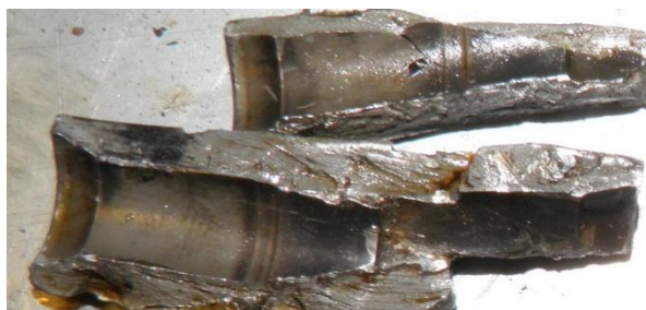
Рис.10. Пример скрытого производственного дефекта, имеющего "неустранимый" характер - нештатная "двойная" галтель в отверстии поршневых пальцев. Дефект было невозможно обнаружить и устранить до тех пор, пока он не привел к полному разрушению ДВС при пробеге 1000 км
