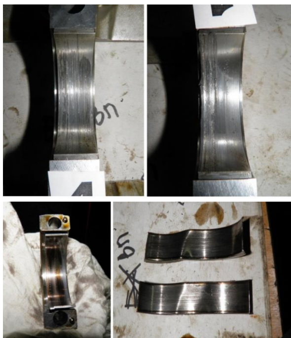
Рис.3. Пример повреждения всех подшипников - и коренных (вверху), и шатунных (внизу), в результате длительной эксплуатации двигателя на мощностных режимах при неисправном маслоснабжении
