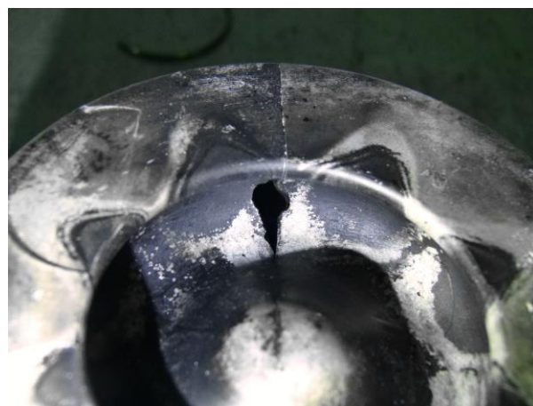
Рис. 6. Трещина в днище дизельного поршня, проходящая вдоль оси пальца - один из признаков нештатного повышения давления наддува в результате "тюнинга" двигателя
