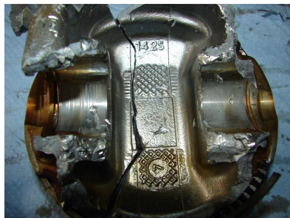
Рис. 2. Усталостное разрушение поршня по избыткам (трещина распространялась от концентратора напряжений в отверстии под палец - края масляного кармана на внутренней поверхности отверстия) вследствие чрезмерных нагрузок, вызванных непродуманной модернизацией серийного двигателя
