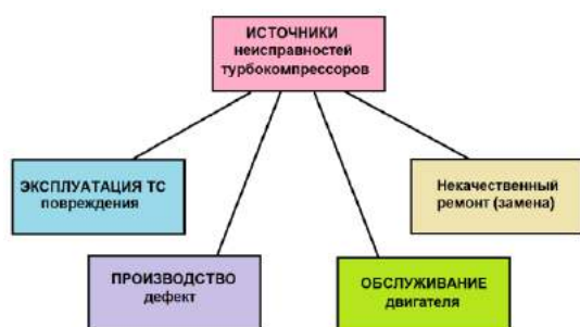
Рис. 7. Источники неисправностей турбокомпрессоров
