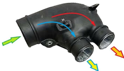
Рис.15. Патрубок с разветвлением потока от воздушного фильтра к турбокомпрессорам правого и левого ряда цилиндров V-образного дизеля
