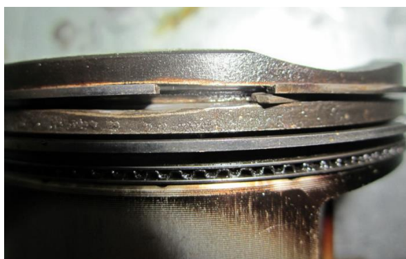
Рис.18. Чрезвычайно сильный избирательный абразивный износ поршня №1 за 80.000 км, при этом в других цилиндрах износа почти нет
