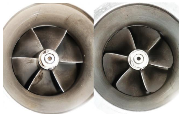
Рис.16. Избирательный газоабразивный износ входных кромок лопаток одного турбокомпрессора из двух за 42000 км пробега автомобиля [9]
