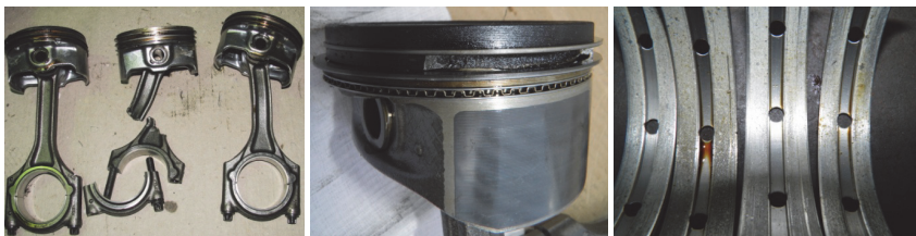
Рис. 1. Некоторые виды неисправностей двигателей, причины которых могут быть выявлены с помощью составления и анализа истории транспортного средства (слева направо): 1- гидроудар в цилиндре (усталостное разрушение шатуна произошло через почти 3000 км пробега от самого момента гидроудара [12]), 2- поломка перемычек между поршневыми кольцами на поршне (заправка топливного бака низкооктановым топливом произошла за более чем 1000 км до появления расхода масла и дымления [13]), 3- полный износ всех трущихся пар, включая подшипники (умышленное добавление в двигатель абразивного песка произошло примерно за 300 км до выхода его из строя [3])
