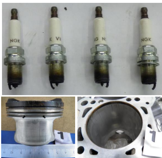
Рис. 9. Поврежденные детали двигателя AUDI-A6
