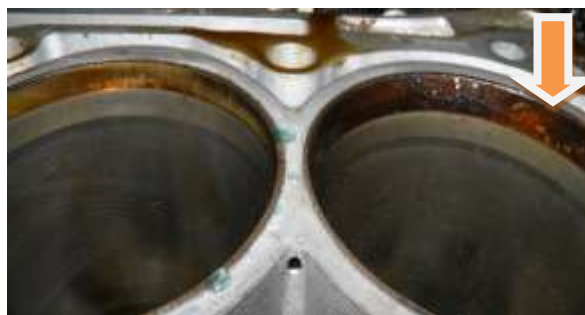
Рис. 19. Расширение пояса нагара в верхней части цилиндра (справа) при работе с деформированным при гидроударе шатуном позволяет однозначно измерить его деформацию
