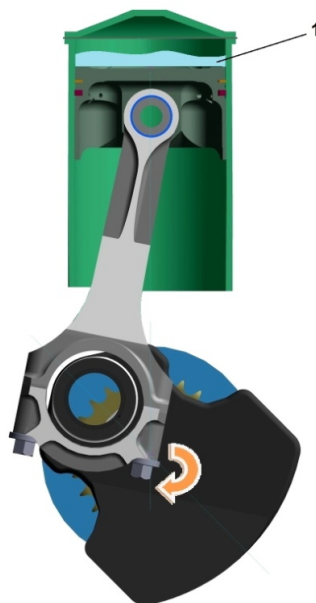
Рисунок 2 – При движении поршня вверх на такте сжатия занятие несжимаемой жидкостью (1) части объема воздуха в цилиндре является вполне ожидаемой причиной более быстрого повышения давления. Figure 2 – When the piston moves upward during the compression stroke, filling by an incompressible fluid (1) of a part of the air volume in the cylinder is a quite expected reason for a more rapid pressure rise.
