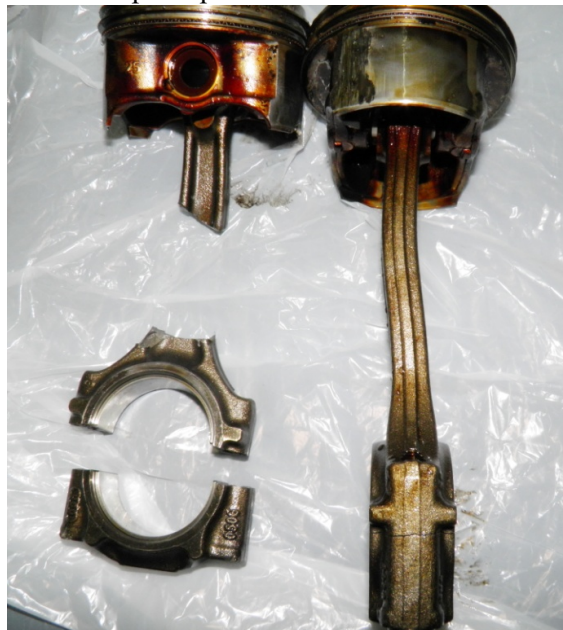
Рисунок 1 – Типичный вид повреждения шатуна при гидроударе в цилиндре ДВС (справа). При дальнейшей эксплуатации это приводит к усталостному разрушению стержня (слева) вследствие нештатных изгибающих нагрузок.
