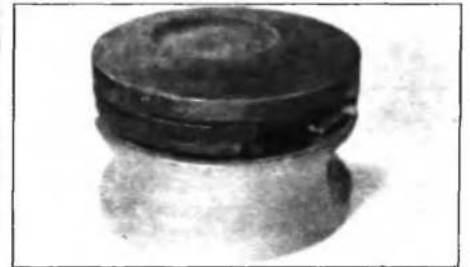
Рис. 4.32. Поршень с помятыми передними кромками между канавками колец
