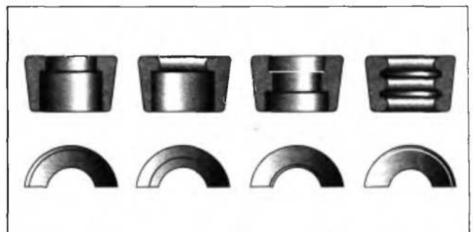
Рис. 2.136. Основные виды сухарей для фиксации тарелок пружин на стержнях клапанов
