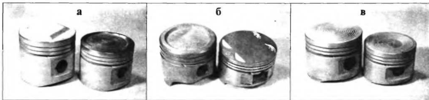
Рис. 2.80. Сравнение поршней двигателей 70-х — начала 80-х годов и конца 80-х — начала 90-х годов: а — BMW; б — GENERAL MOTORS; в — FORD
