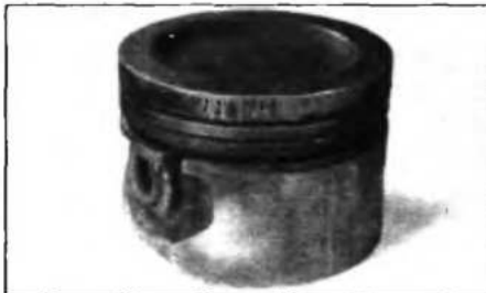
Рис. 4.29. Глубокие задиры на огневом поясе поршня
