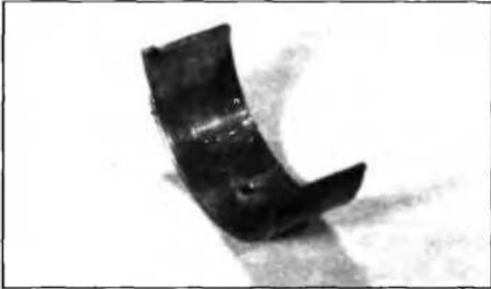
Рис. 4.9. Усталостное разрушение (выкрашивание) рабочего слоя вкладыша
