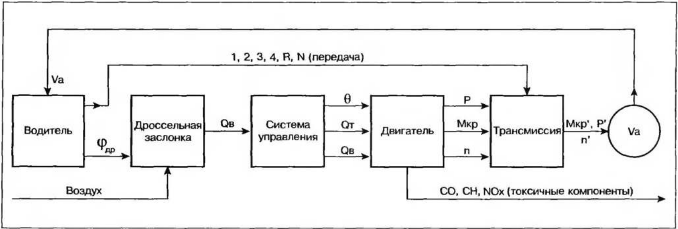
Рис. 3.1. Упрощенная схема управления двигателем с искровым зажиганием:
