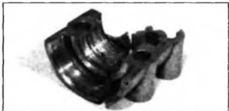
Рис. 4.44. Поломки крышек подшипников распределительного вала при работе без масла
