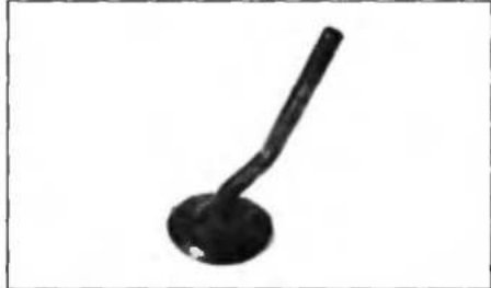
Рис. 4.42. Деформация клапана после удара поршня
