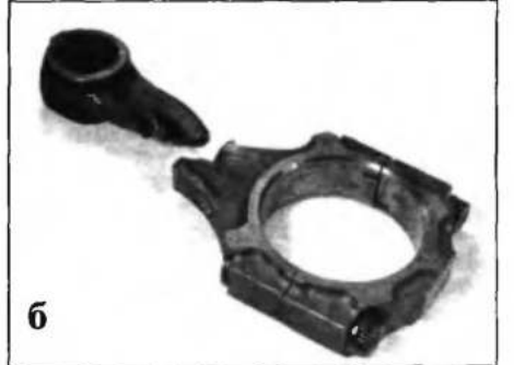
Рис. 4.21. Результаты гидроудара в шатуне: а — деформация шатуна; б — поломка шатуна
