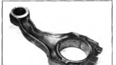
Рис. 4.21. Результаты гидроудара в шатуне: а — деформация шатуна; б — поломка шатуна
