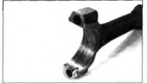
Рис. 4.20. Задиры на поверхности отверстия нижней головки шатуна после проворачивания вкладыша
