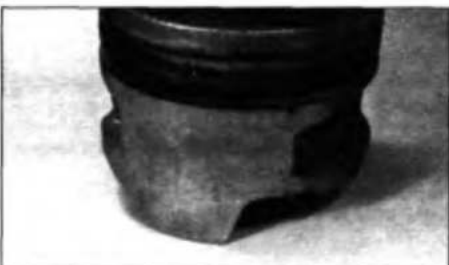
Рис. 4.26. Абразивный износ юбки из-за плохой фильтрации масла и/или воздуха
