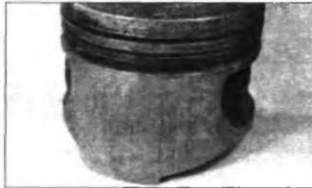
Рис. 4.27. Незначительные задиры в середине юбки поршня из-за переобогащения топливо-воздушной смеси
