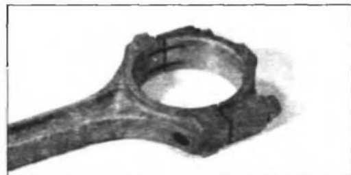
Рис. 2.74. Шатун современного двигателя с "коло-тым" разъемом крышки
