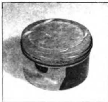
Рис. 2.93. Поршень современного двигателя с графитовым покрытием юбки
