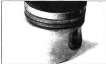
Рис. 4.28. "Затертость" огневого пояса часто свидетельствует об износе юбки поршня или большом зазоре в цилиндре
