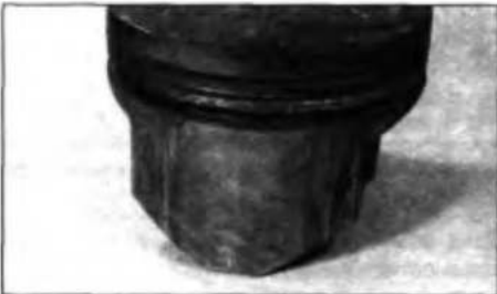
Рис. 4.24. Типичный задир на юбке поршня при перегреве двигателя
