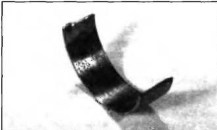
Рис. 4.16. Вкладыш с полностью разрушенным рабочим слоем
