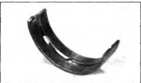
Рис. 4.12. Вкрапления мелких частиц в рабочий слой вкладыша из-за абразивного износа или разрушения других деталей двигателя
