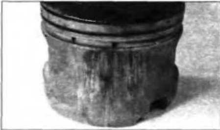
Рис. 4.23. Задир в верхней части юбки поршня из-за недостаточной смазки
