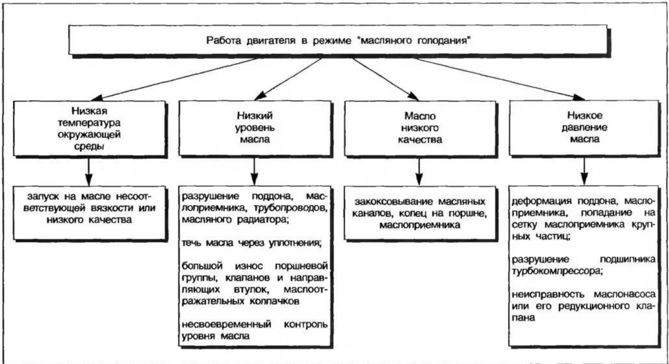
Рис. 4.2. Основные причины возникновения режима "масляного голодания"
