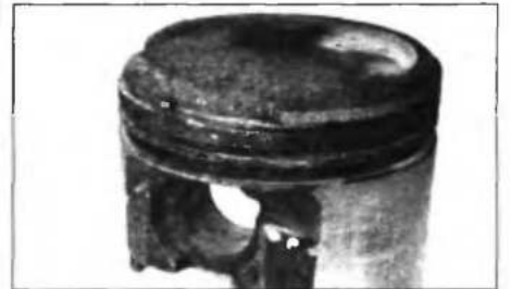
Рис. 4.33. Эрозия на краях днища и огневом поясе поршня
