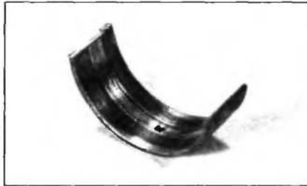
Рис. 4.13. Глубокая борозда на рабочей поверхности из-за попадания посторонних частиц в систему смазки
