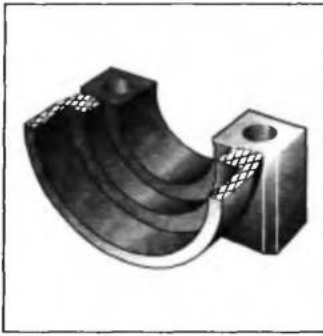
Рис. 10.19. Крышка заднего коренного подшипника с проточкой для установки сальника: XXXX — места герметизации стыка крышки с блоком для исключения течи масла
