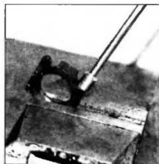
Рис. 10.47. Затягивание шатунных болтов
