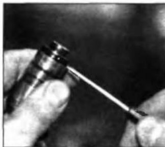
Рис. 10.64. Разборка гидротолкателя развальцовкой запорного кольца
