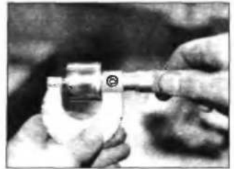
Рис. 10.62. Измерение толщины доньшка толкателя при подборе регулировочных шайб для точной установки зазоров в приводе клапанов
