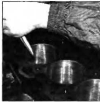
Рис. 10.39. Притупление острого края цилиндра шабером для облегчения установки поршней с кольцами
