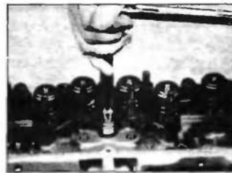
Рис. 10.68. Затягивание болтов головки блока цилиндров с помощью динамометрического ключа
