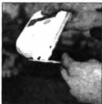
Рис. 10.13. Смазка детали маслом перед установкой с помощью масленки, изготовленной из фляги с маслом
