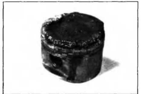
Рис. 12.9. Расплавление поршня из-за калильного зажигания вследствие установки слишком "горячих" свечей зажигания
