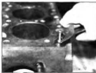
Рис. 10.67. Снятие центрирующей втулки (болт, установленный в отверстие втулки, препятствует ее деформации)
