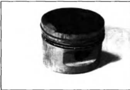
Рис. 12.2. Задиры и прижоги на рабочей поверхности поршневых колец из-за малого теплового зазора в замках
