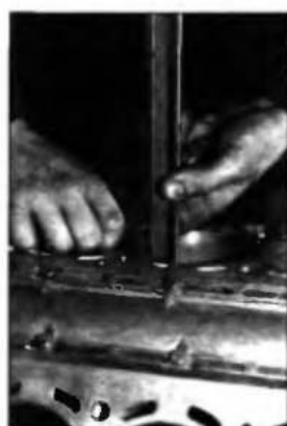
Рис. 10.5. Проверка перпендикулярности поверхности цилиндра к верхней плоскости блока с помощью лекальной линейки и угольника
