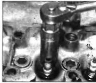
Рис. 10.82. Затяжка свечей зажигания посредством динамометрического ключа (трещотки)
