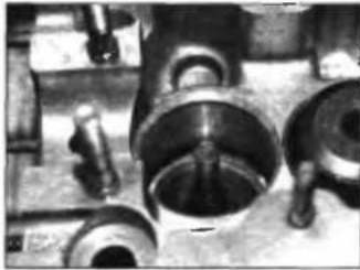
Рис. 10.57. Пластмассовая втулка на стержне клапана для предохранения маслоотражательного колпачка от повреждения рабочей кромки при его установке
