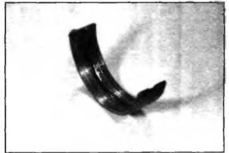
Рис. 12.8. Коренной вкладыш после непродолжительной работы двигателя с деформированным коленчатым валом
