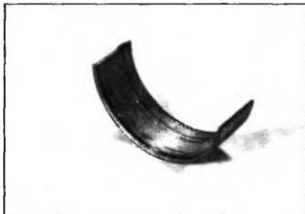
Рис. 12.6. Повреждение рабочего слоя вкладыша (риски) из-за некачественной мойки деталей перед сборкой двигателя
