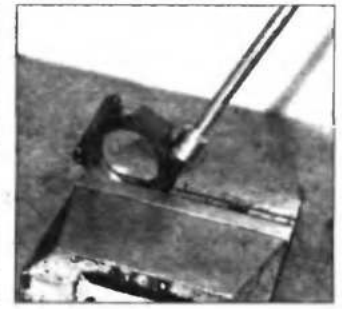
Рис. 9.50. Зажим шатуна для затяжки или ослабления болтов осуществляется только за нижней головку, чтобы не деформировать стержень
