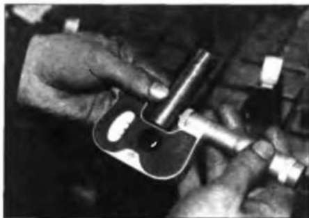
Рис. 8.18. Измерение диаметра (износа) поршневого пальца рычажной скобой-пассажиметром
