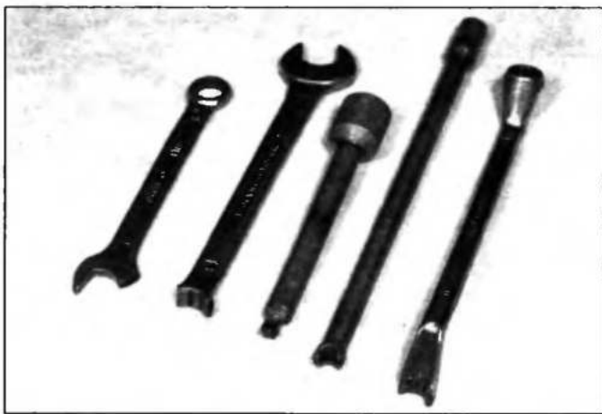
Рис. 5.15. Полоток инструмента вследствие недостаточной квалификации персонала ремонтного предприятия
