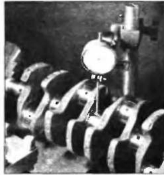
Рис. 9.8. Измерение деформации (биения) вала в центрах токарного станка
