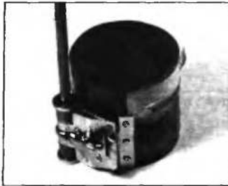
Рис. 5.47. Ленточная оправка для обжатия поршневых колец
