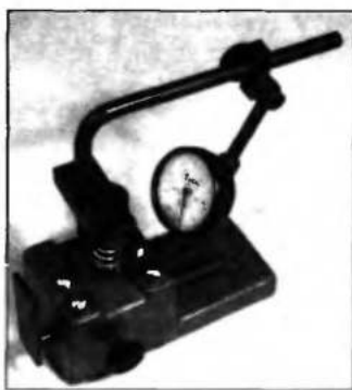
Рис. 5.39. Приспособление для контроля деформации стержней клапанов
