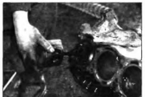
Рис. 7.6. Выталкивание поршня с шатуном из цилиндра
