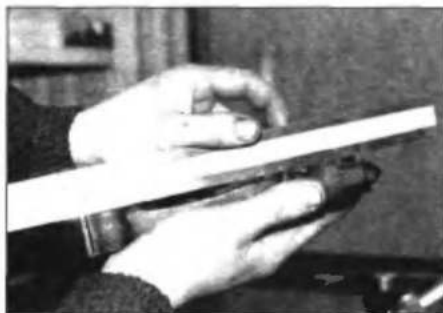
Рис. 8.20. Проверка деформации шатуна с помощью лекальной линейки
