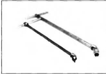
Рис. 5.9. Т-образные ключи с карданом для различных типов болтов
