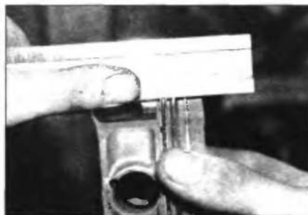
Рис. 8.22. Контроль выступания дисков маслосъемного кольца над наружной поверхностью расширителя
