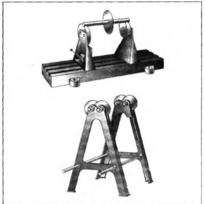
Рис. 9.44. Роликовые (дисковые) стенды для статической балансировки валов
