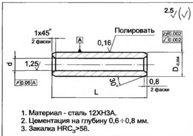
Рис. 9.123. Эскиз для изготовления поршневого пальца
