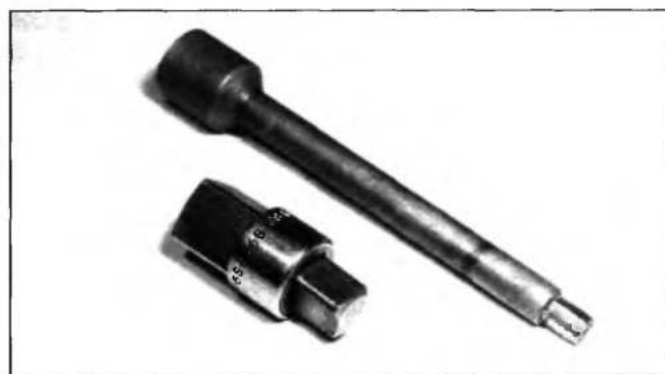
Рис. 5.5. Переходники с одного размера квадрата на другой
