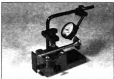
Рис. 8.41. Проверка деформации стержня клапана с помощью специального прибора
