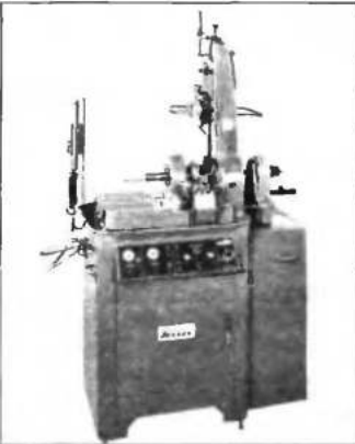
Рис. 5.82. Специализированный станок для расточки отверстий головок шатунов
