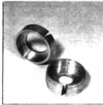
Рис. 9.64. Разрезные оправки для доработки вкладышей в токарном станке
