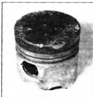
Рис. 9.132. Поршень с поврежденным днищем
