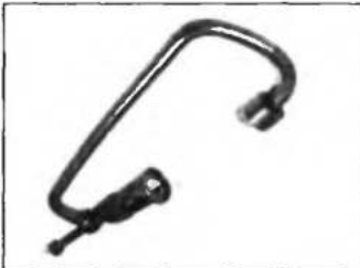
Рис. 5.48. Винтовое приспособление для разборки/сборки пружин клапанов на снятой головке блока цилиндров
