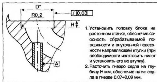
Рис 8.47. Эскиз обработки гнезда седла клапана
