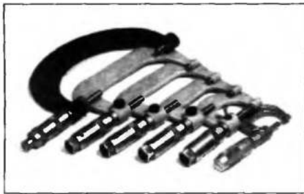
Рис. 5.16. Микрометры для измерения наружных диаметров деталей в диапазоне 0-125 мм с точностью 0,01 мм
