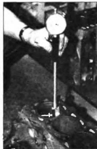
Рис. 8.11. Контроль износа цилиндра в верхней наиболее изношенной части
