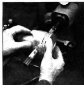
Рис. 9.122. Хонингование отверстия в поршне под поршневой палец на горизонтально-хонинговальном станке
