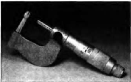
Рис. 5.31. Специальный микрометр для измерения толщины деталей с криволинейной поверхностью
