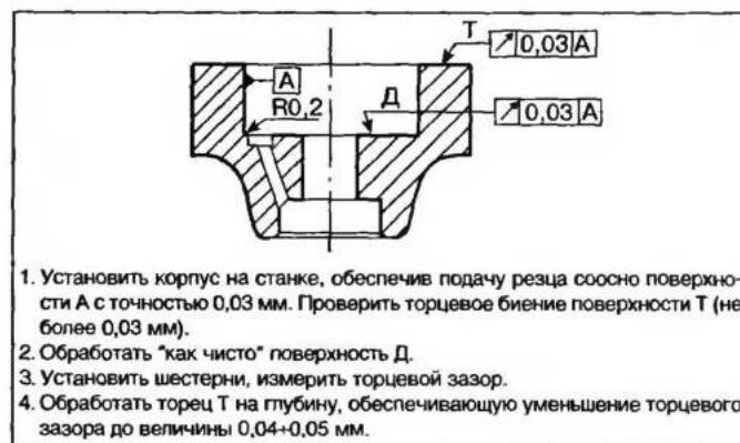
Рис 8.48. Эскиз обработки изношенного корпуса роторного масляного насоса
