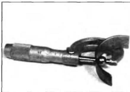
Рис. 8.8. Измерение толщины вкладыша микрометром через шарик
