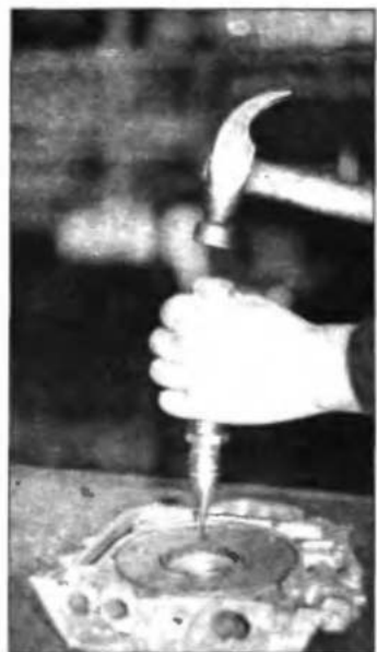
Рис. 7.19. Отворачивание винтов крышки масляного насоса с помощью ударной отвертки
