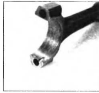
Рис. 9.49. Шатун с поврежденным отверстием нижней головки
