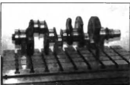
Рис. 5.28. Вал на призмах, установленный на поверочной плите
