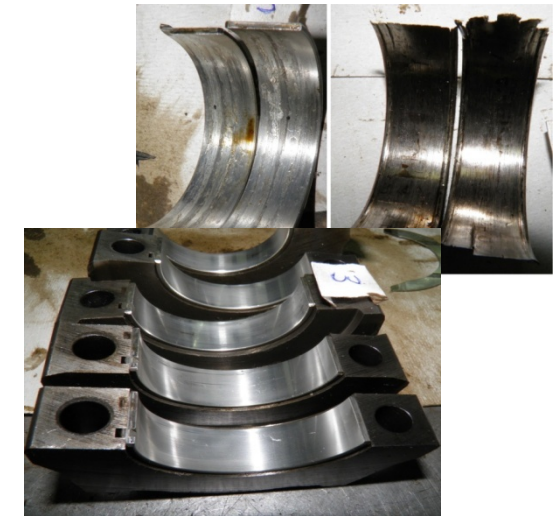
Типичный пример повреждения шатунных подшипников при отсутствии повреждений коренных подшипников.
