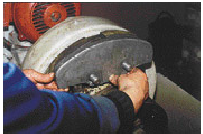
Балансировочные грузы подбираются для каждого вала
