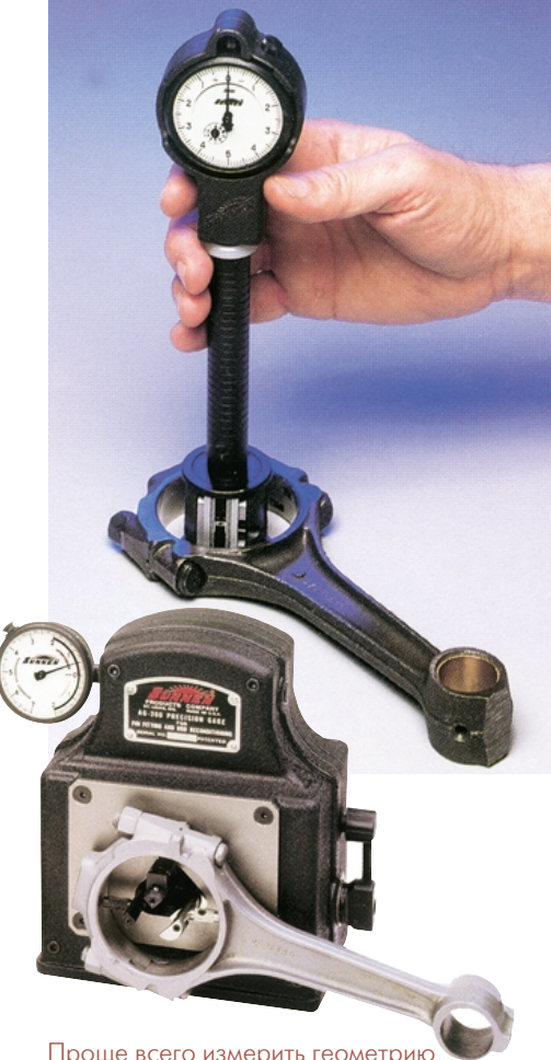
Проще всего измерить геометрию отверстия нутромером (а), но иногда используют и специальные приборы (б).
