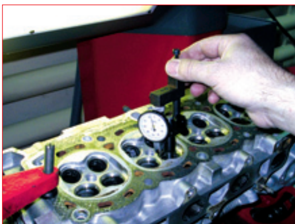
Точное измерение биения седла — специальный прибор SERDI тоже не обманул наших ожиданий.
