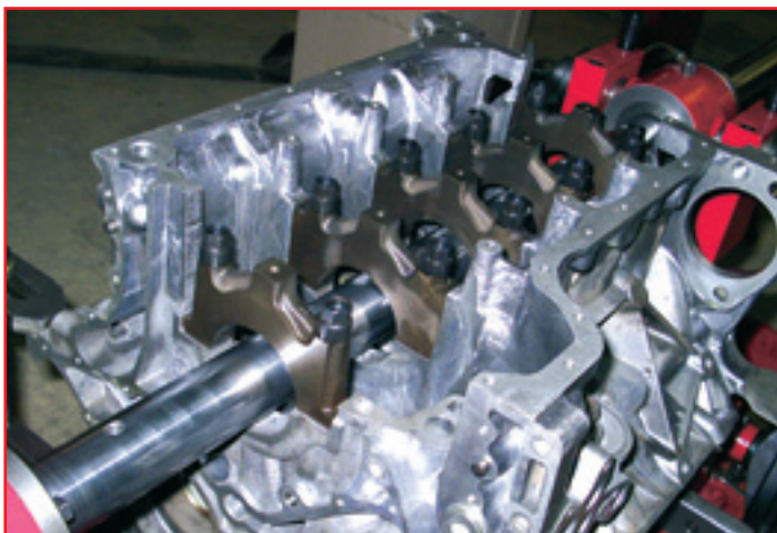
Постели коленвала в блоках цилиндров, включая V-образные, растачиваются аналогично постелям распредвалов в головках. Разница — только в размерах борштанги.
