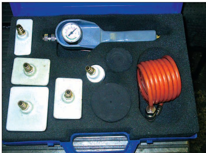
Вакуумтестер — неперенный элемент грамотной технологии ремонта ГБЦ.
