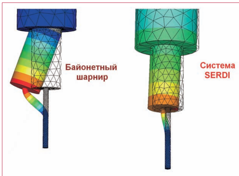
Деформация в байонетной системе при усилии 10 кг и пилоте 7 мм превышает аналогичную в жесткой системе в 5 раз. Шарнир между шпинделем и резцом, однако. Есть над чем задуматься, не правда ли?
