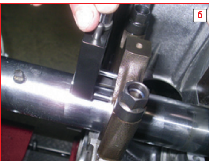
Очень удобный нутромер (а). С помощью ножек, вставляемых в зазор между борштангой и постелью (б), он позволяет контролировать полученный размер постели, что называется, «из-за угла», ничего не разбирая и не снимая со станка.
