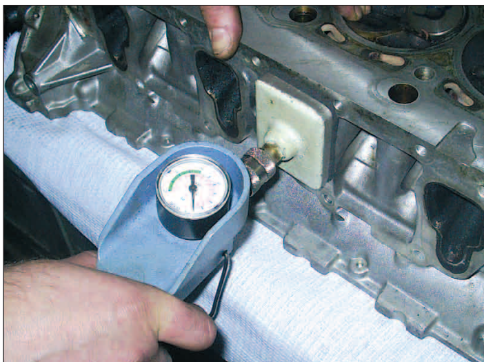
Быстрая и надежная проверка герметичности посадки клапанов — без нее работа не может считаться законченной.
