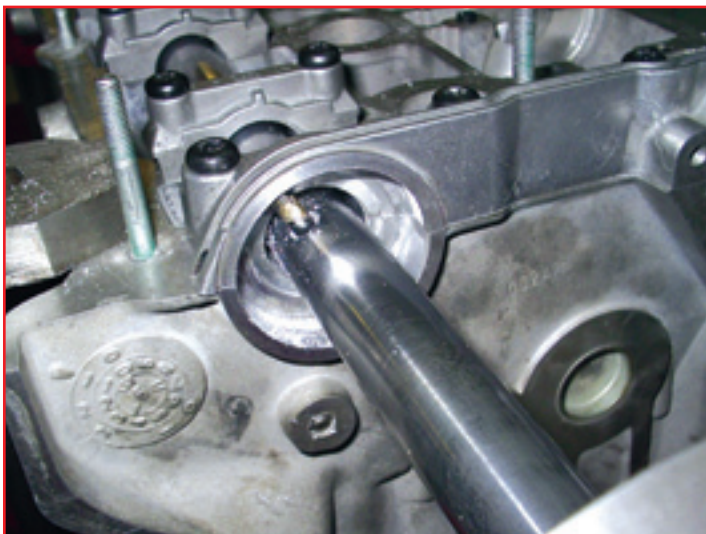
Завершающая операция — правка посадочной поверхности под сальник распредвала. Без этого ремонт не будет качественным.
