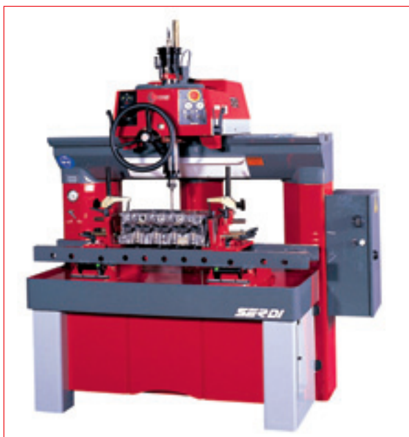
Станок SERDI 4.0 Power — один из самых мощных и универсальных во всей программе фирмы
