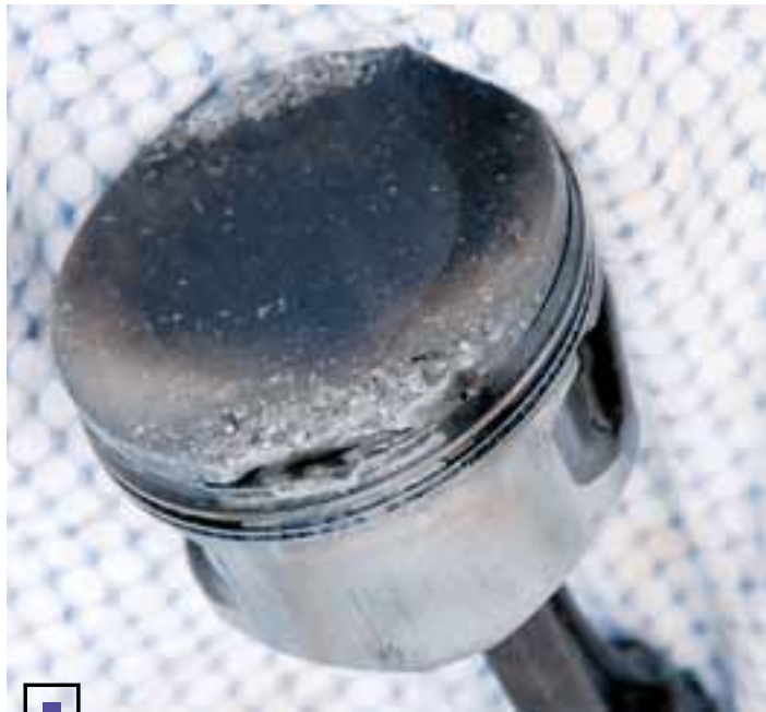
Так выгладит не вполне характерный пример разрушения поршня в результате детонации — каверны буквально «съели» металл на краях
