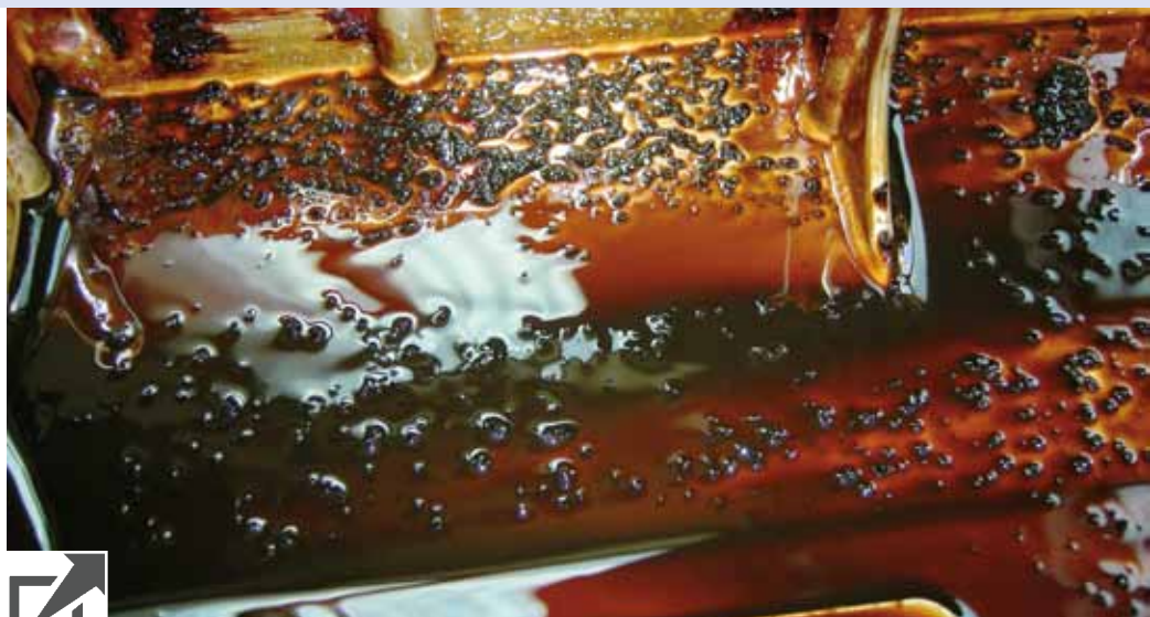
Вот они, частицы твердого черного нагара, провалившиеся в поддон
