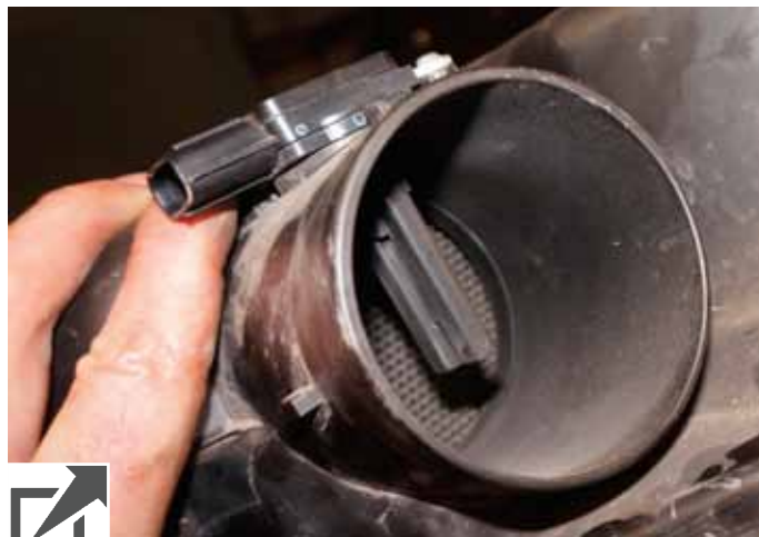
Первый признак нарушения качества фильтрации воздуха – пыль на стенках выходного патрубка корпуса воздушного фильтра
