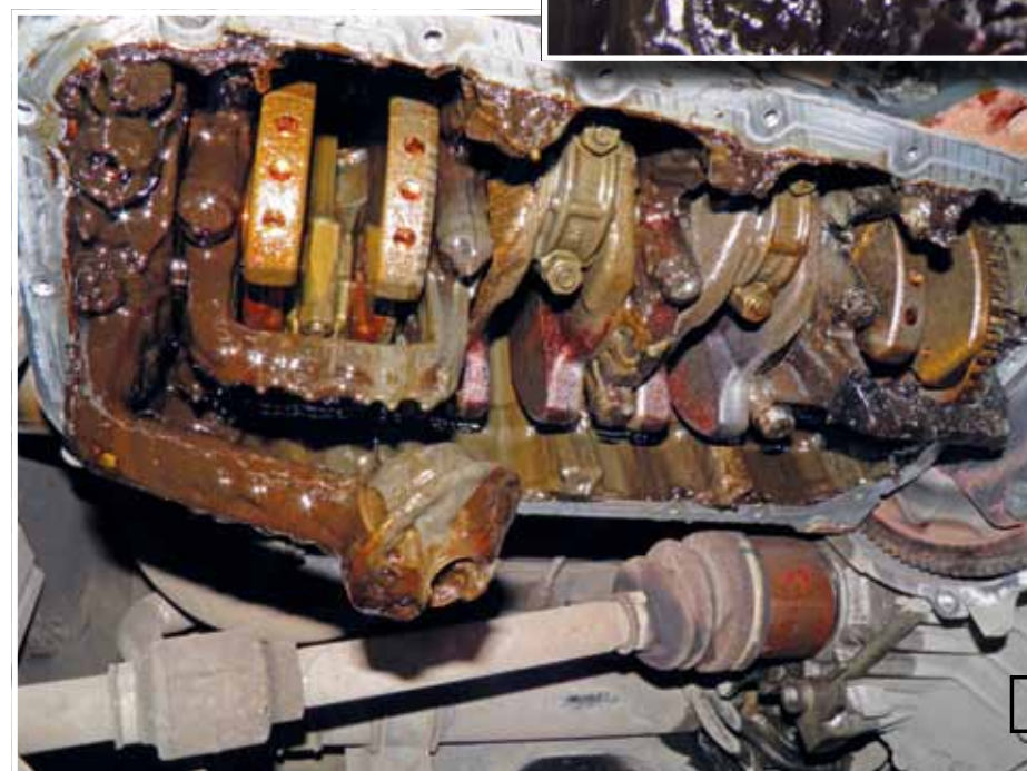
Снизу в двигателе на всех неподвижных деталях такой же «гуталин»
