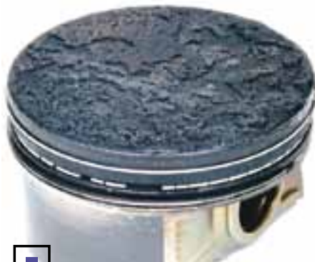
Разрушение поршневых колец – еще один явный признак низкого качества топлива
