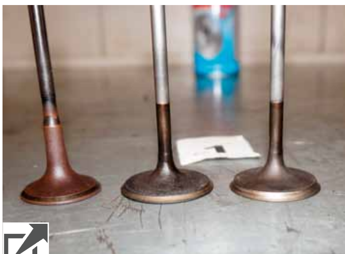
Если выпускной клапан еще мог бы послужить (слева), то у впускных клапан абразивная пыль затерла стержни. А у некоторых так потрудились над рабочей фаской, что сделала ее кромку острой как бритва (справа)
