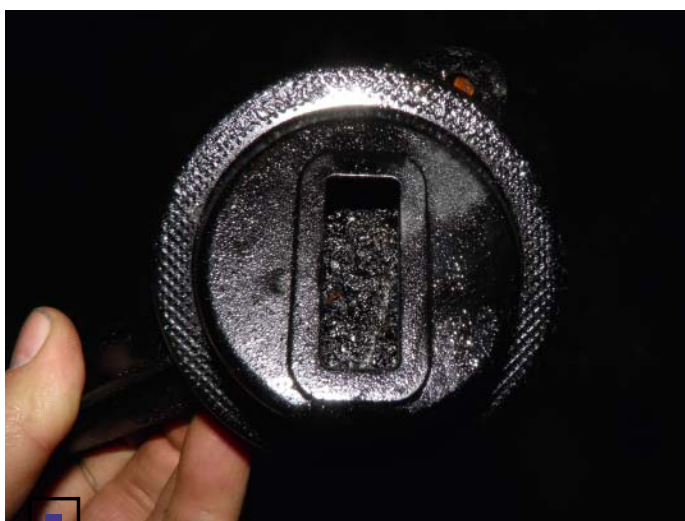
Типичный результат выполнения ТО через рекомендованные 15–20 тыс. км — полностью забитый нагаром маслоприемник, через который уже не пройдет ни грамма масла
