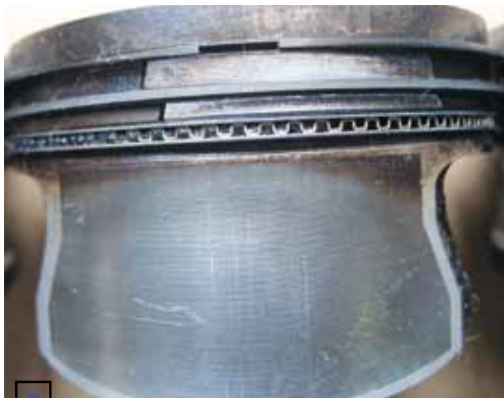
А вот и «классика» детонации — рухнувшие перемычки на поршне
