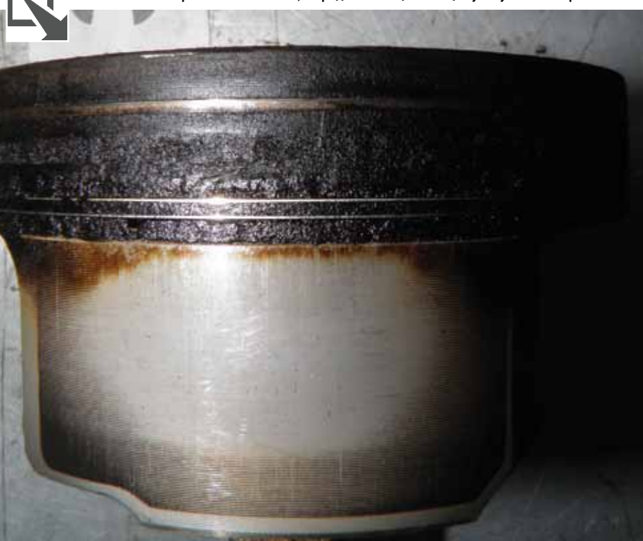
Вот такой “уникальный” поршень был вынут из мотора - все поршневые кольца полностью блокированы в канавках, а среднее кольцо вообще “утонуло” в нагаре
