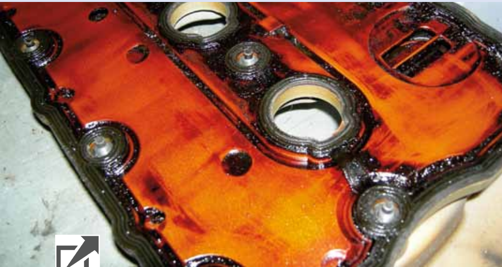
Следы нагара видны даже на клапанной крышке
