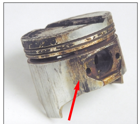
Задир на юбке поршня — типичный результат перегрева двигателя.
