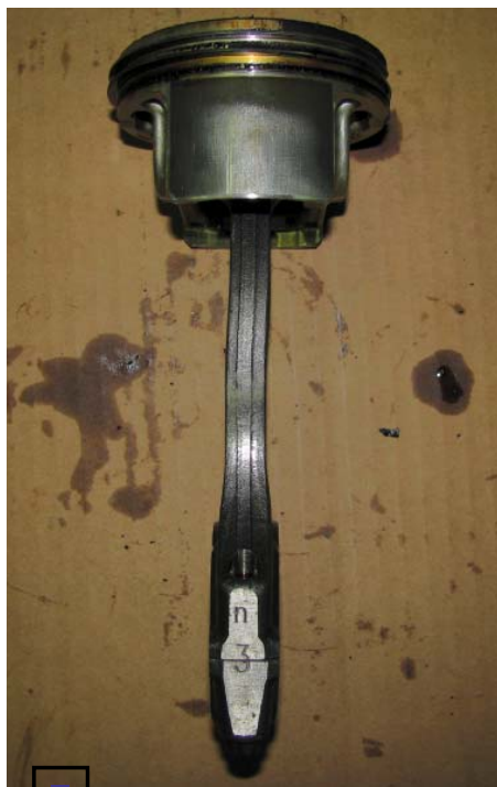
Признак третий — характерная «змеяка» на шатуне, потерявшем устойчивость в результате осевого сжатия
