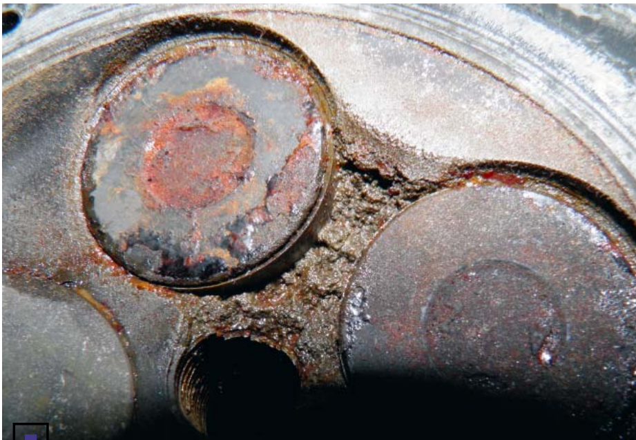
Плавление стенки камеры сгорания между выпускными седлами – еще один признак сильного перегрева
