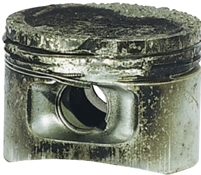
б) начало плавления поврежденного поршня;
