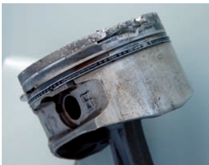
Характерные результаты детонации — эрозия поверхности поршня и разрушения в области огневого и уплотнительного поясов
