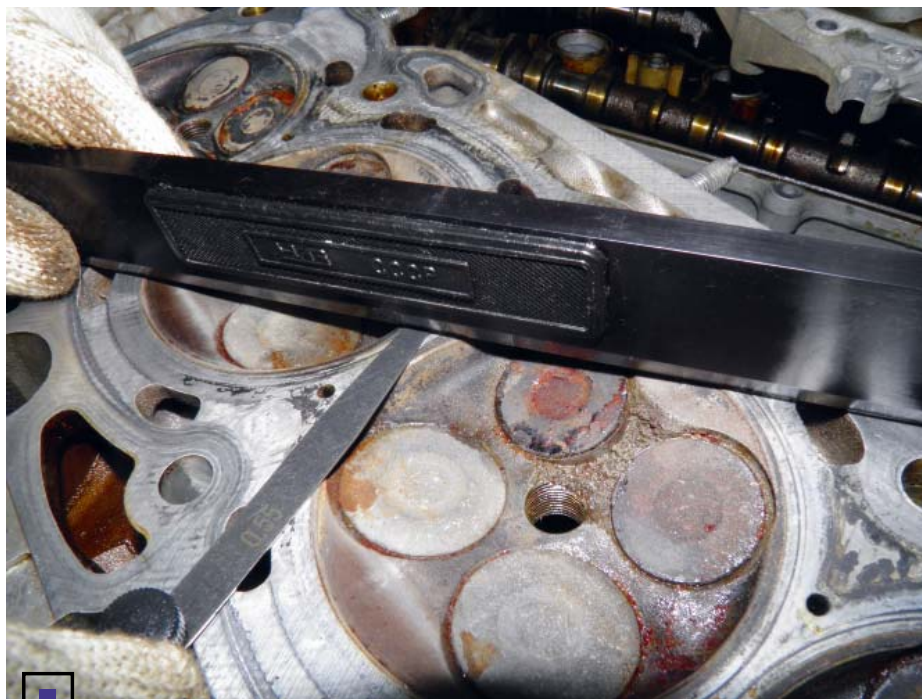
□ Типичный признак перегрева двигателя в его начальной стадии — деформация плоскости головки блока
