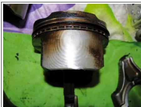
Диагональное пятно контакта на юбке поршня
