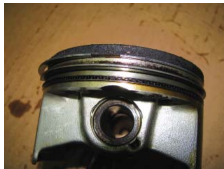
Признак четвертый — следы перекоса поршня в цилиндре
