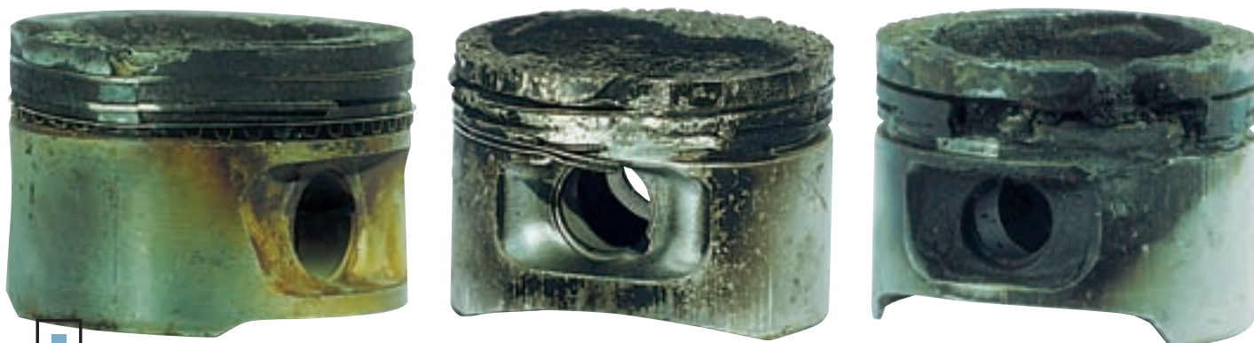
□ Если отвод тепла через уплотнительный пояс затруднен, а тепловая нагрузка на поршень велика, процесс быстро развивается от температурной деформации к частичному оплавлению и, наконец, полному прогоранию поршня (слева направо)
