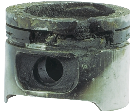
в) прогар верхнего уплотнительного пояса поршня.
