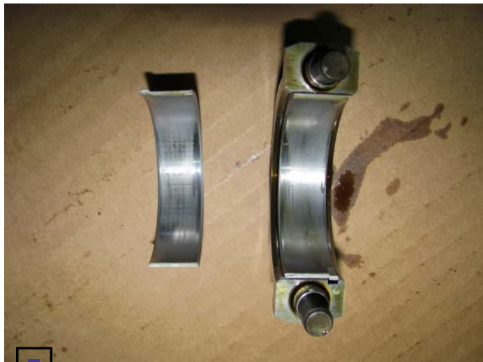
Признак шестой — диагональный след работы шатунных вкладышей с перекосом
