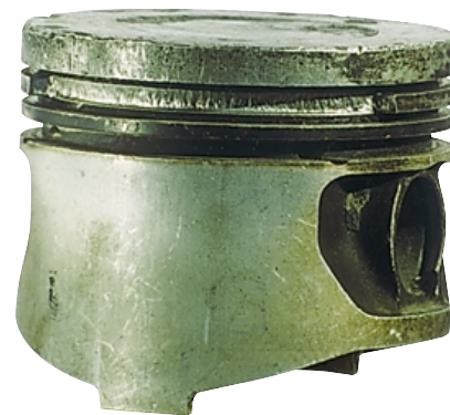
Поломанная перемычка на поршне — типичный результат детонации.
