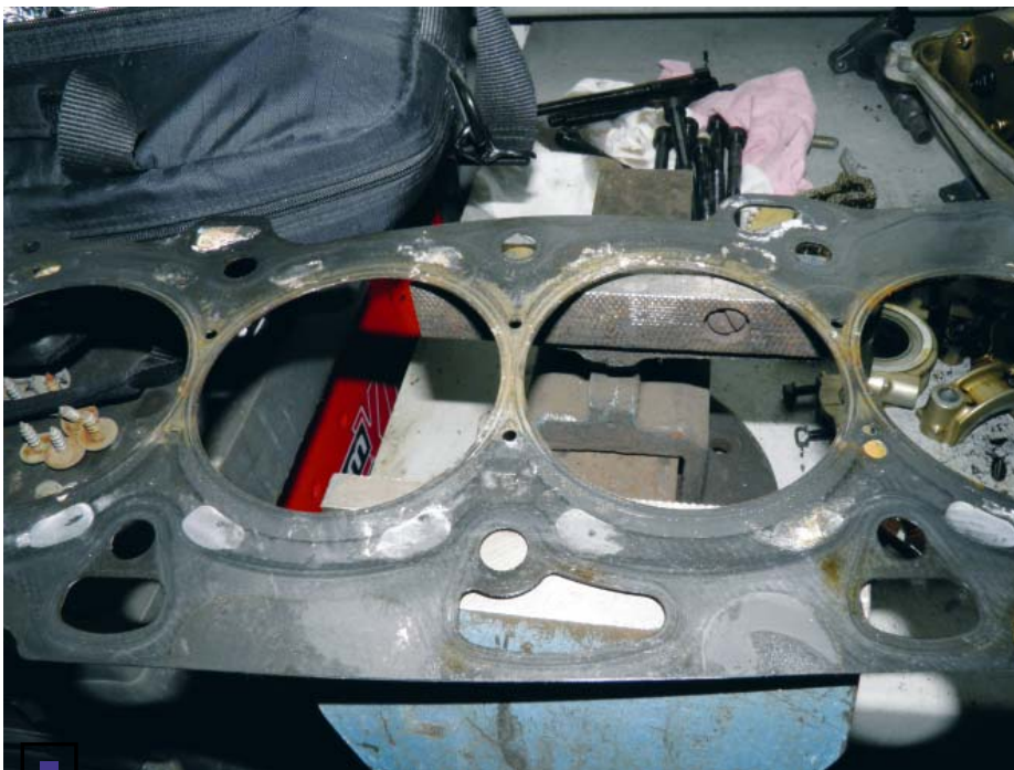
Потеря герметичности прокладки ГБЦ при сильном перегреве – видны характерные участки прорыва газов из цилиндров
