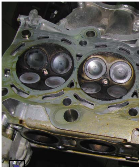
Признак седьмой — повышенное нагарообразование в поврежденной (крайней левой) камере сгорания
