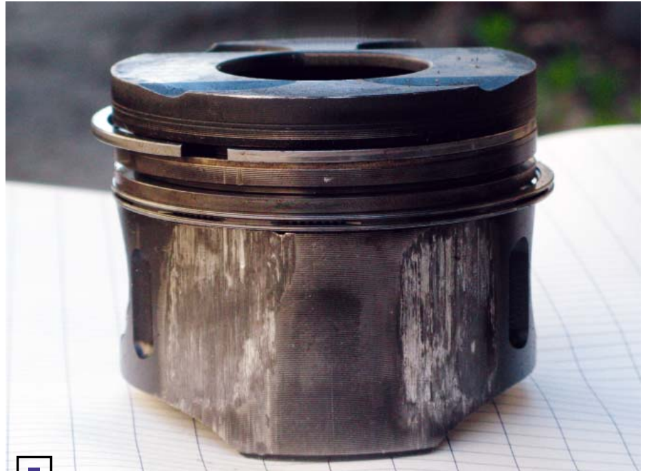
Отсутствие охлаждения цилиндра вызывает расширение поршня вдоль пальца – с появлением задигов на краях юбки
