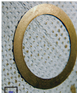
□ Шайбы обработаны для придания поверхностям повышенной шероховатости
