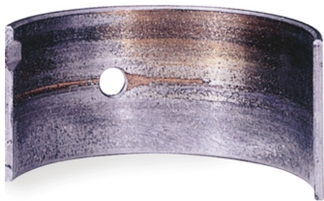
Абразивный износ вкладышей легко установить по матовой рабочей поверхности, рискам и стиранию верхнего слоя.
