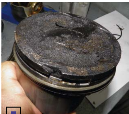
□ Предыдущие эксперты единодушны: поршень прогорел из-за использования некачественного бензина
