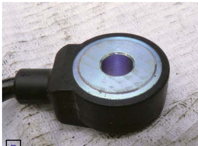
Датчик детонации после проведенных экспериментов показал свою исправность
