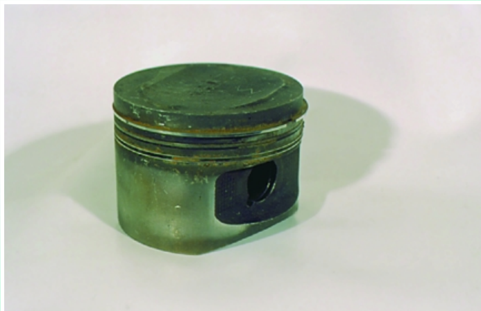
Коррозия после длительной стоянки явилась причиной потери подвижности колец в канавках поршня и поступления большого количества масла в цилиндр
