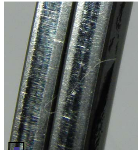
□ Поясок приработки на рабочей поверхности сломанного кольца (справа) заметно уже, чем у целого
