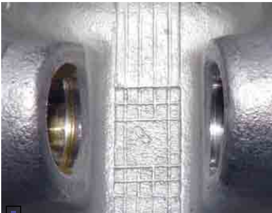
...что видно по характерной выработке на краю отверстия бобышки
