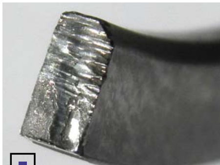
Изломы кольца частично заполированы, но в среднем удалось обнаружить признаки усталостного разрушения
