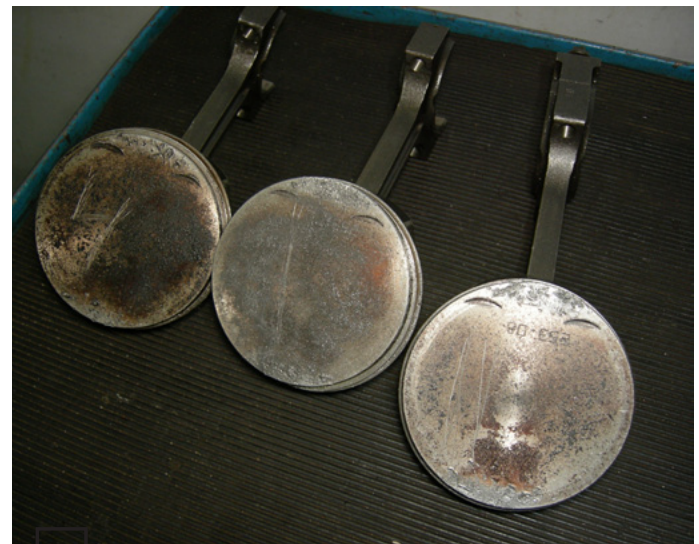
Следы от клапанов есть на всех поршнях
