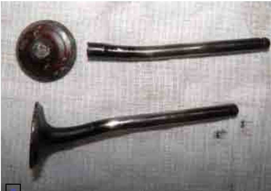
А вот и сам «оборванец» — судя по соседнему гнутому клапану обрыв случился от удара поршня
