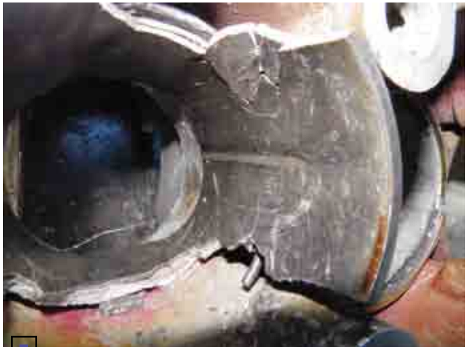
Гильза цилиндра разрушилась, а двигатель превратился в грудку железа...
