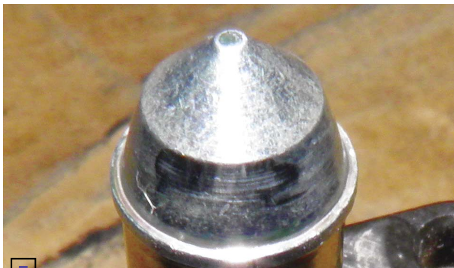
После того как узел промыли, на игле клапана стал ясно виден след от затертости
