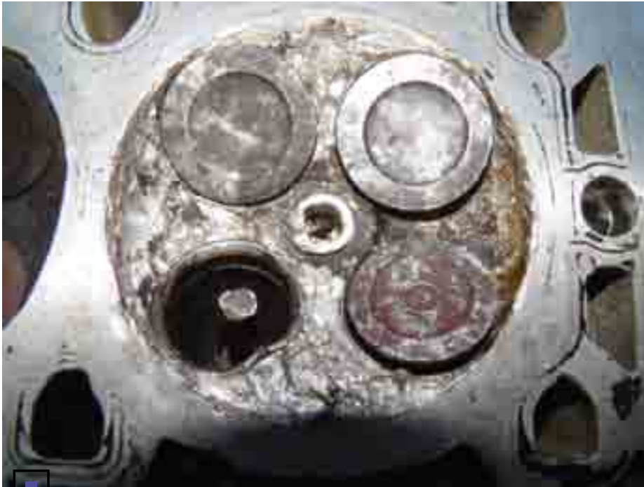
Обрыв тарелки клапана для камеры сгорания никогда не проходит бесследно
