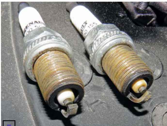
Свечи были исправны и имели хорошую искру
