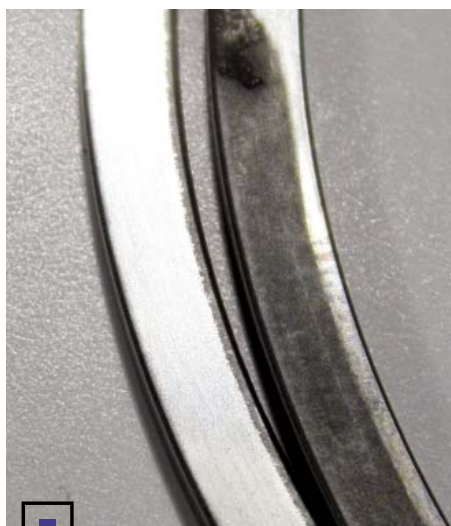
□ Сравнение характера износа нижних торцов нормального (слева) и сломанного (справа) колец показывает, что поврежденное кольцо не работало как должно
