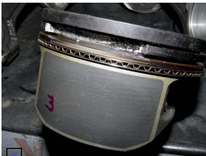
Один из поршней, подвергшихся атаке детонации. Надеемся, комментарии не требуются
