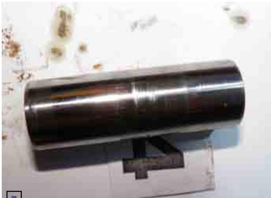
Несимметричные следы приработки на пальце - типичные признаки его сдвига и вращения в отверстии верхней головки шатуна
