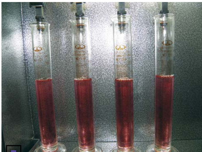
Форсунки на всякий случай проверили на стенде, но нареканий в их работе — не нашли
