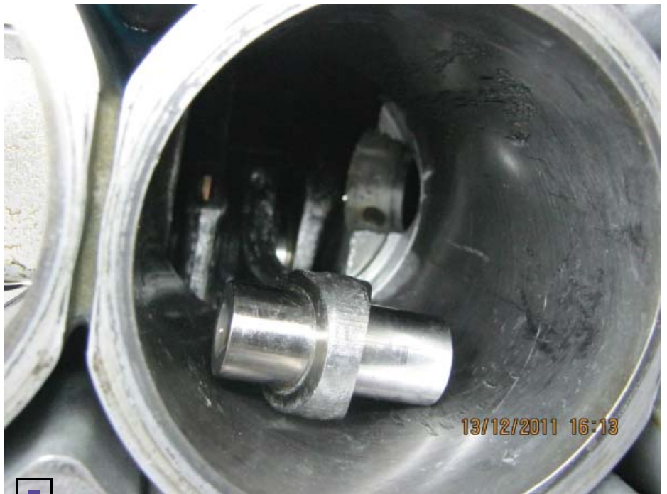
Шатун и палец на моторе «Мерседеса» почти как новые, а поршня — нет...
