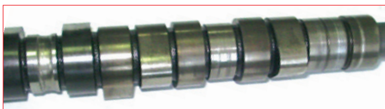
При недостаточной подаче масла опорные шейки распределительного вала могут получить серьезные повреждения. В такой ситуации распредвал лучше заменить, чем ремонтировать.
