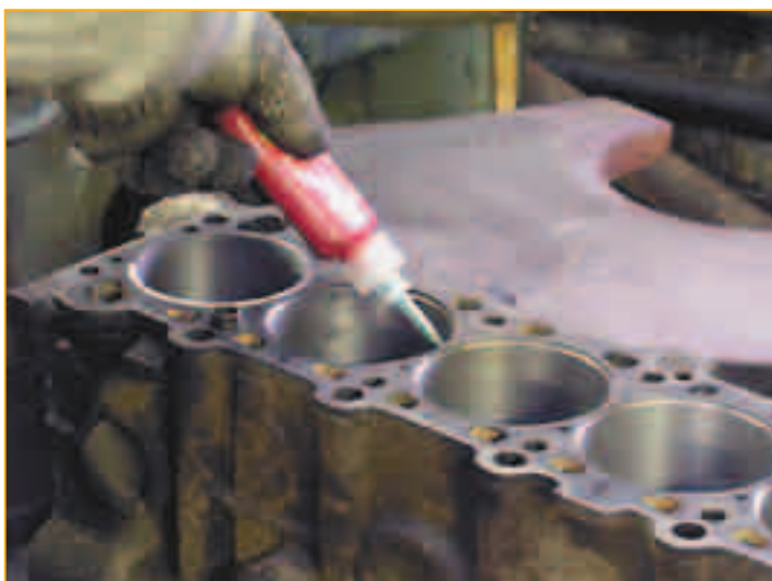
Для надежности на верхнюю область стенки цилиндра наносится специальный герметик. Если выявлена негерметичность стенки, делать это нужно обязательно, причем нужно также покрыть герметиком и нижнюю часть цилиндра.
