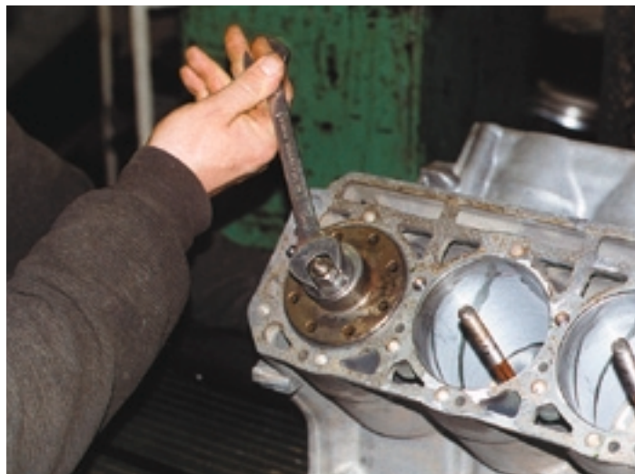
Убедиться в том, что гильза встала «на место», помогает резьбовая шпилька.
