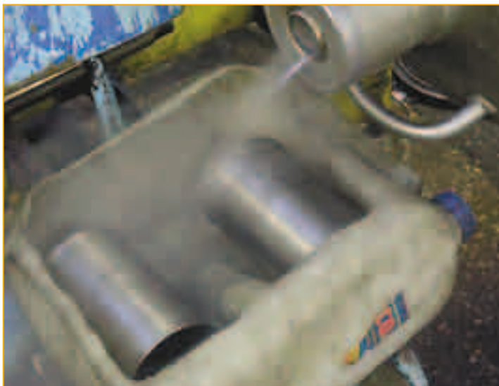
Необходимый перепад температур между блоком и гильзой можно создать, охладив гильзы в жидком азоте. Такой способ требует минимальных затрат времени и не снижает работоспособности деталей.
