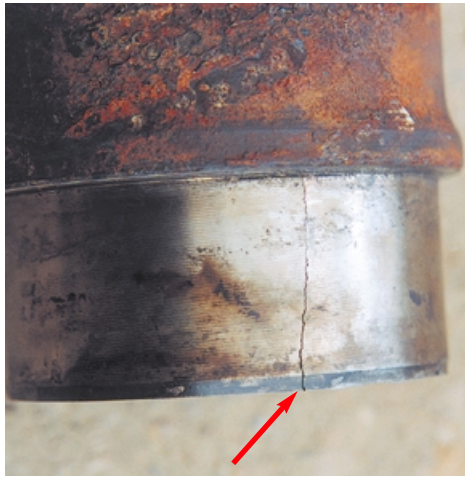
Из-за удара шатуна на гильзе образовалась трещина.
