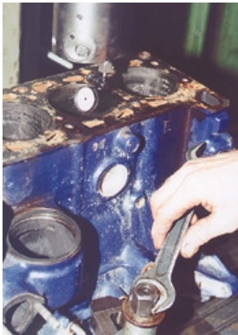
Поставив блок на скалку, необходимо отрегулировать положение блока в поперечном направлении.
