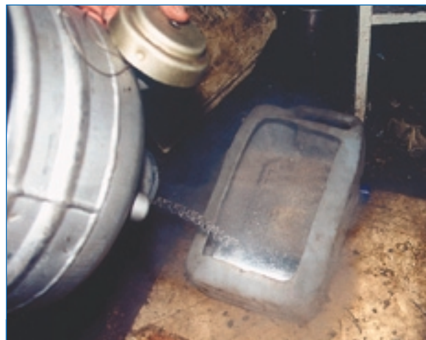
Жидкий азот для гильзы — отрада моториста!
