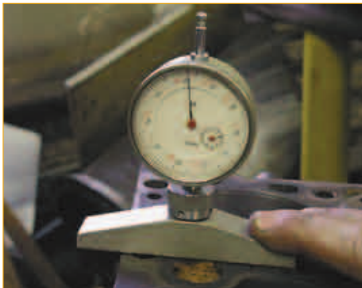
После выравнивания температуры деталей блока измеряется выступание гильзы и сравнивается с расчетной величиной, отмеченной в технологической карте. Если значения совпадают, можно двигаться дальше.
