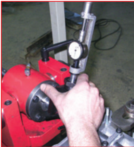
Для точной настройки вылета резца используется еще один прибор, делающий эту операцию быстрой и удобной.
