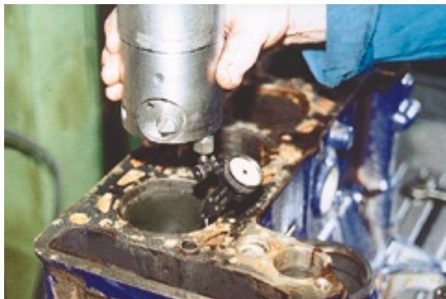
Поставив блок на скалку, необходимо отрегулировать положение блока в поперечном направлении.
