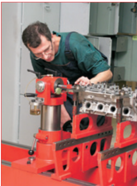
Одно из главных преимуществ расточного станка — индивидуальная выверка положения детали с целью достижения минимального смещения оси постелей. В конечном счете это и делает расточку постелей универсальной ремонтной технологией.
