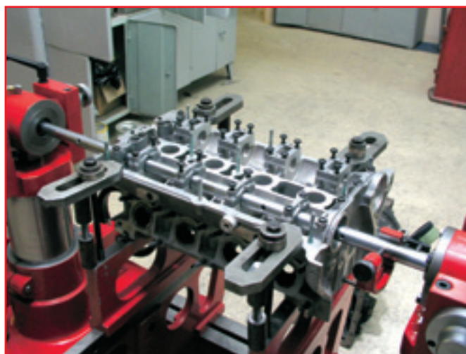
Теперь головка блока подготовлена к расточке.
