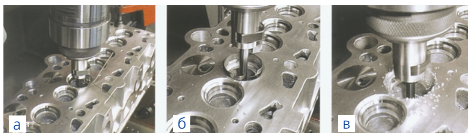
Чтобы удалить старое седло, его растачивают (а) до момента, пока оставшееся тонкое кольцо не провернется (б). После чего гнездо растачивают «как чисто» или под готовое новое седло (в).
