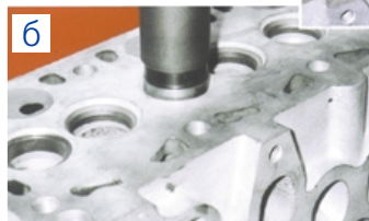
Установка нового седла выполняется с помощью оправки (а) ударным способом (б).
