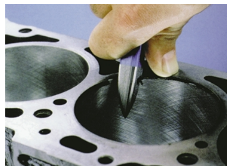
Чтобы не повредить кольца, на краю цилиндров надо сделать небольшую фаску.
