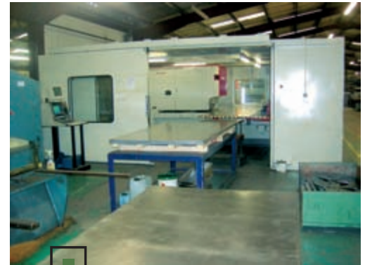
Изготовление корпусов установок начинается с раскроя металла на серьезном центре с ЧПУ.
