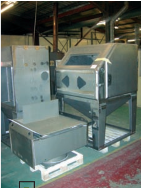
После формования панелей корпуса свариваются вручную сварщиками высшей квалификации и поступают в окраску.
