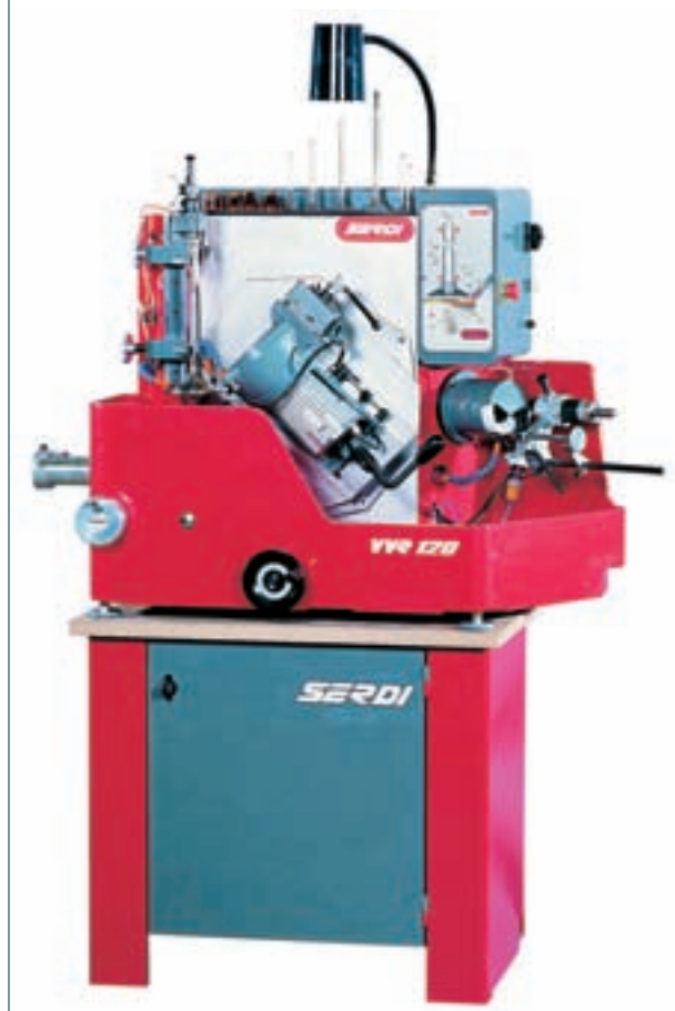
«Роллс-Ройс» среди шлифовальных станков для клапанов - модель SERDI VVR120, выполнена по усовершенствованной люнетной схеме с вертикальным расположением клапана. Аналогов по точности, производительности и диапазону размеров клапанов не имеет. Как, впрочем, и «Роллс-Ройс» среди прочего автомобильного племени.
