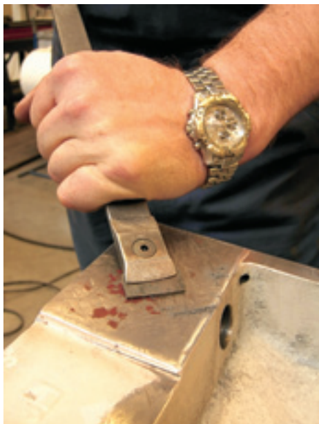
Типичная операция подгонки деталей — обычная в производстве станков, но долгая, а потому совершенно нереальная в серийном производстве. Ее всегда поручают самым опытным работникам.
