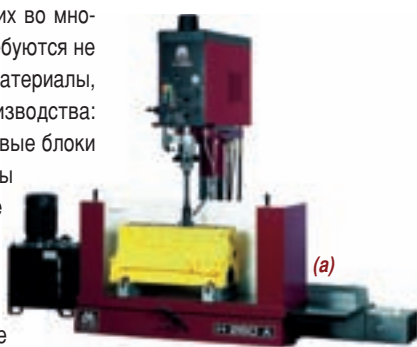
На современном хонинговальном станке (а) тоже все предусмотрено — для качественной работы достаточно следовать инструкции, остальное «додумает» сам станок. Рядом с ним отечественный образец (б) выглядит явным анахронизмом.
