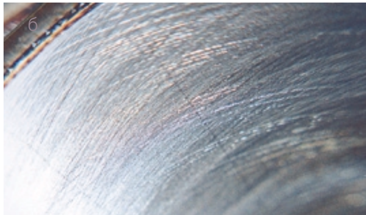
Поверхность цилиндра после хонингования на отечественном станке с постоянной скоростью подачи хонголовки (а) имеет более четкие риски, нежели после хонингования на станке иностранного производства (б). Зернистость брусков в обоих случаях одинакова и равна 100.
