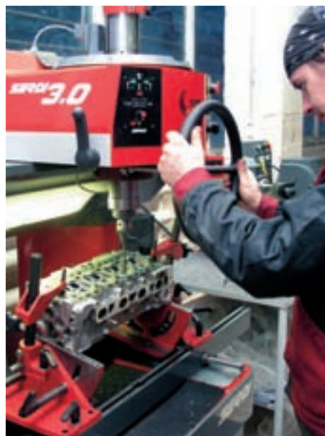
Станок для обработки седел в головках блока цилиндров никогда не выпускался в нашем отечестве. Как никогда не готовились специалисты-«головочники» для работы на нем. Но в современном моторном ремонте без такого станка просто нечего делать...
