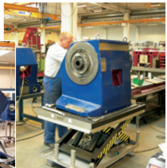
Сборка шлифовального станка — дело кропотливое и долгое. Роботов с конвейерами не видно — все вручную, что и делает любой такой станок дорогостоящим.
