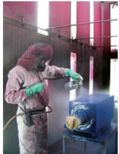
Окраска детали станка производится тоже не на автоматической линии.
