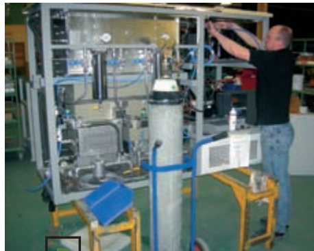
Машина для ультразвуковой очистки работает по замкнутому циклу, полностью изолированному от окружающей среды. Используется для высокоэффективной очистки, в том числе деталей авиационных агрегатов.
