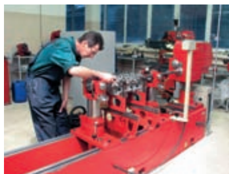
Еще один специализированный станок — горизонтально-расточной для расточки постелей подшипников. Завидная универсальность, позволяющая расточить любые соосные отверстия в диапазоне 22–200 мм при любом обзримом габарите головки или блока цилиндров. Устаревшие отечественные аналоги давно не выпускаются, сравнивать не с чем...
