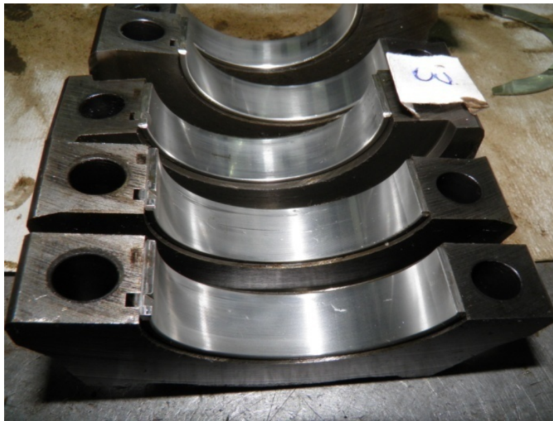
Рис.6.1. Типовий приклад пошкодження шатунних підшипників (а) за відсутності помітних пошкоджень корінних підшипників (б) – звичайний результат експлуатації двигуна з недостатнім рівнем оливи.
