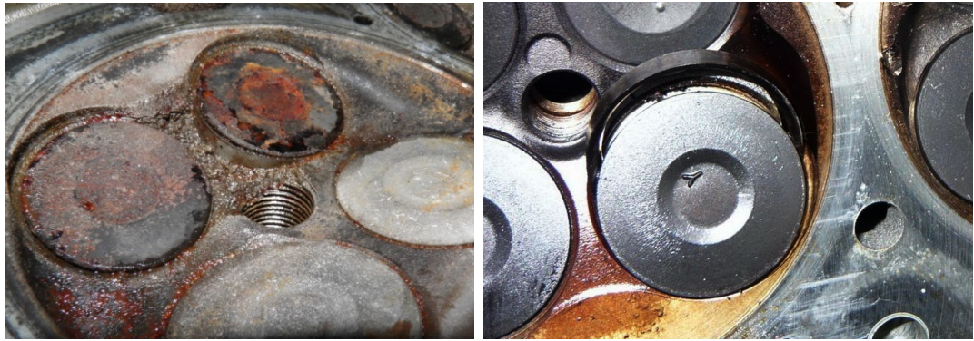
Рис.5.2. Камера згоряння зі слідами плавлення стінки між сідлами випускних клапанів, пошкоджена на номінальному режимі роботи ДВЗ під час руху (а) та випадок випадання сідел при перегріві від втрати ОР на режимі малих оборотів та навантажень при роботі ДВЗ на місці (б)
