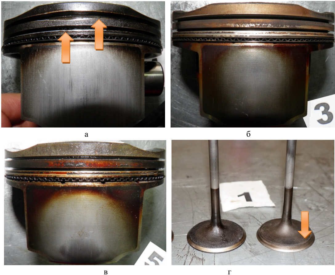
Рис. 3.5. Поршні та клапани двигуна V6 з колектором, зображеним на рис.3.3, після експлуатації з нештатним повітряним фільтром: а – поршень №1 (стрілками показані надзвичайно зношені канавки кілець), б – поршень №3, в – поршень №5, г – клапани циліндра №1 (стрілкою показаний сильно зношений клапан, розташований далі від входу в колектор)
