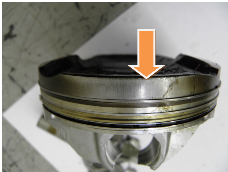
Рис.4.4. Сліди роботи поршня з перекосом у циліндрі після гідроудару
