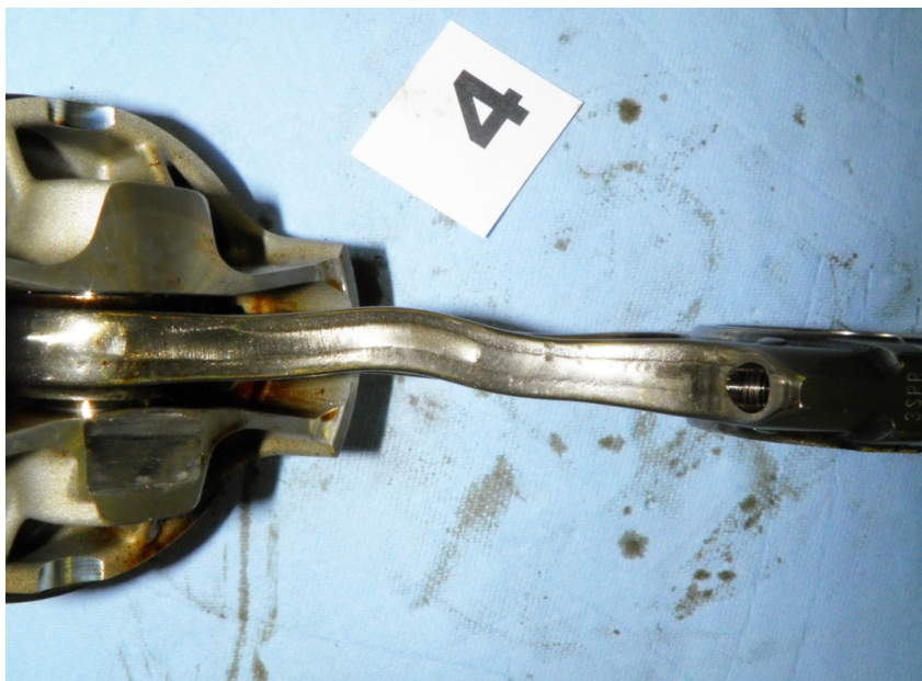
Рис. 4.1. Типова форма стрижня шатуна при гідроударі в циліндрі після втрати стійкості
