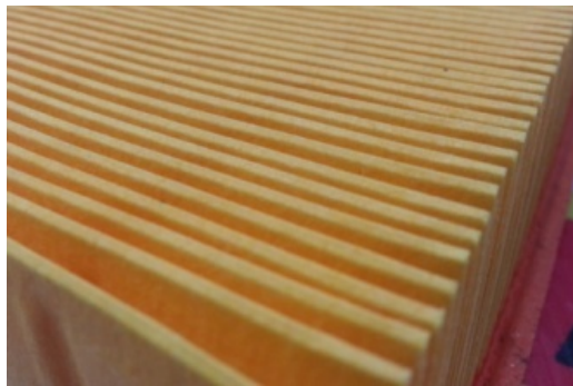
Рис.3.6. Традиційний паперовий повітряний фільтр, що базується на затриманні частинок за допомогою ефекту "сита".
