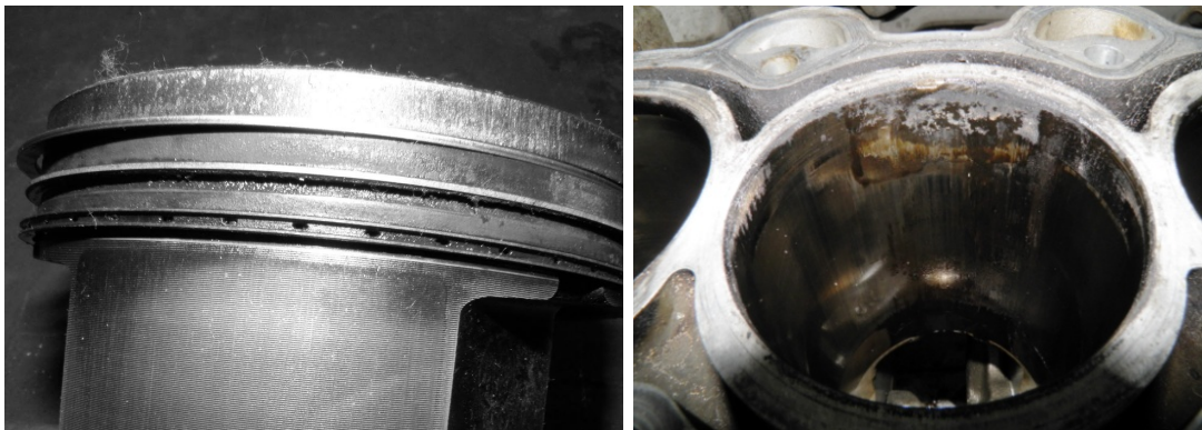
Рис.5.3. Задираки на верхній частині поршня (а) і циліндра (б) бензинового двигуна при втраті ОР
