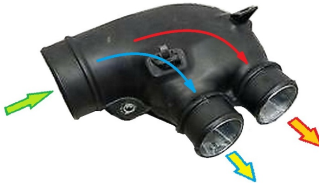
Рис.3.1. Патрубок з розгалуженням потоку від повітряного фільтра до турбокомпресорів правого та лівого ряду циліндрів V-подібного дизеля.
