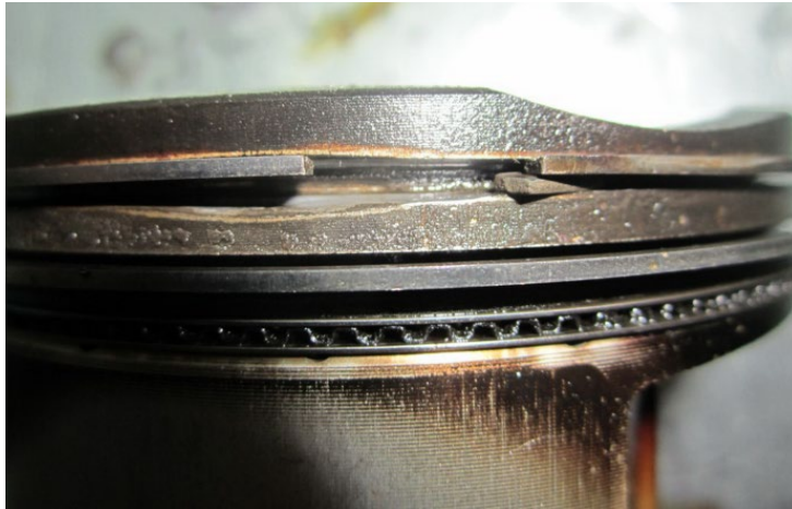
Рис.3.4. Надзвичайно сильне виборче абразивне зношування поршня №1 за 80.000 км, при цьому в інших циліндрах зносу майже немає.
