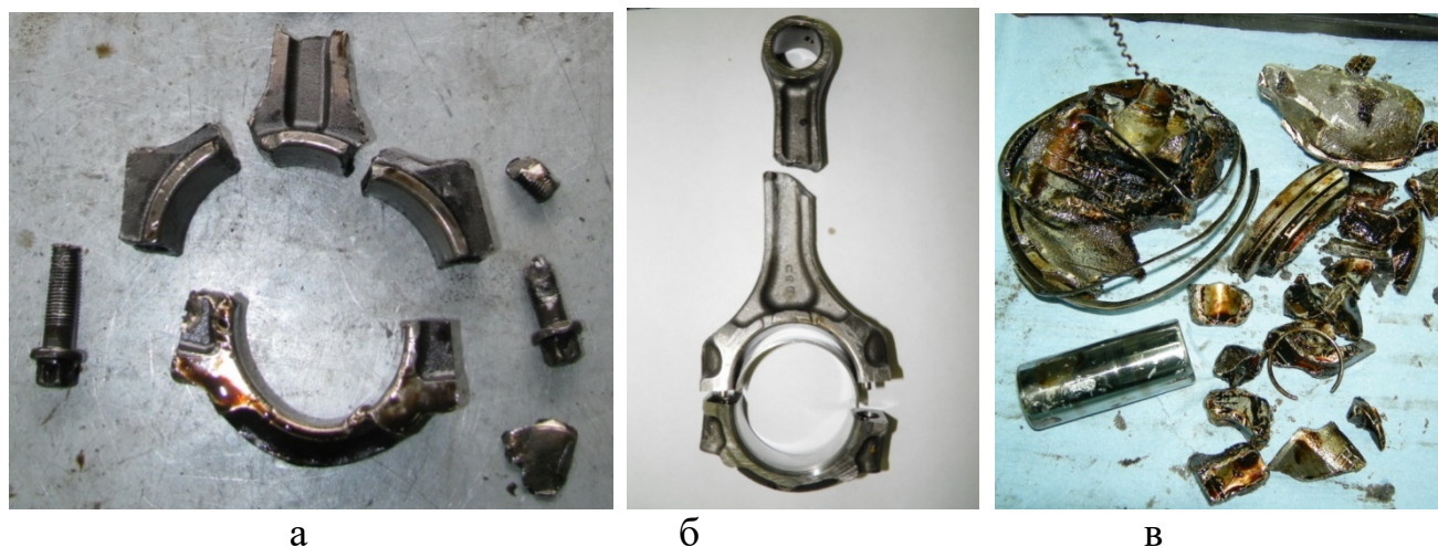
Рисунок 1 – Приклади пошкоджень двигунів з порушенням синхронізації зворотно-поступального та обертального руху деталей: а – від недостатньої подачі оливи, б – після гідроудару, в – після руйнування клапана
