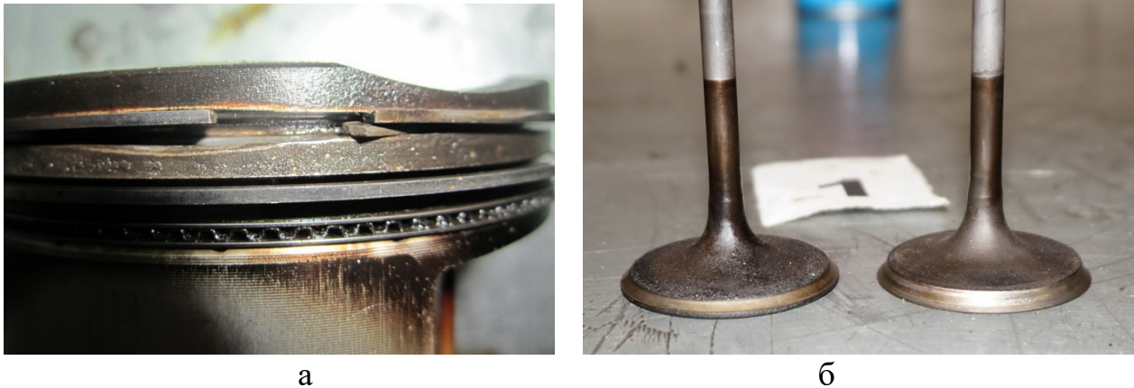
Рисунок 25 – Вибірковий (локальний) абразивний знос: а – поршня; б – клапана
