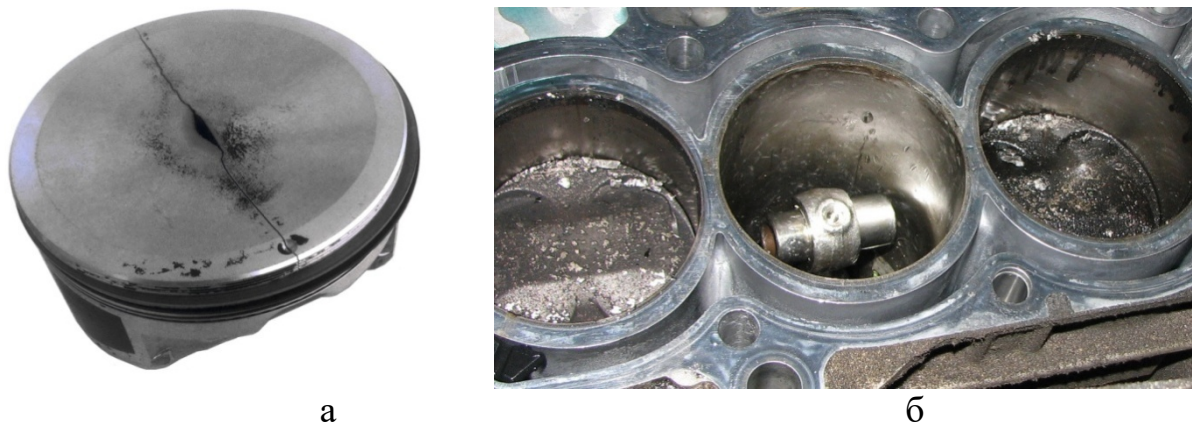
Рисунок 26 – Руйнування поршня в наслідок перевантаження: а – від перевищення тиску наддуву; б – від перевищення допустимої частоти обертання
